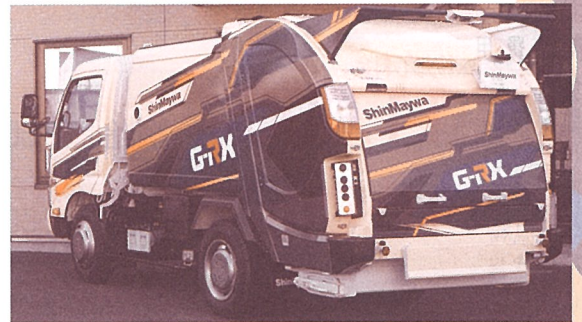
回転板式塵芥車「G-RX」 写真提供:新明和工業株式会社
